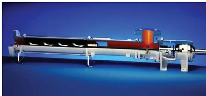
Дальнейшие улучшения конструкции и использование новых материалов позволило нам уменьшить размеры Flexishaft что сделало насосы сравнимыми по длине с другими шнековыми насосами традиционной конструкции, присутствующими на рынке. Пользователю предоставляется возможность получить модернизированный насос вместо существующего и при этом существенно снизить эксплуатационные расходы за счет устранения подверженной износу конструкции карданного соединения
